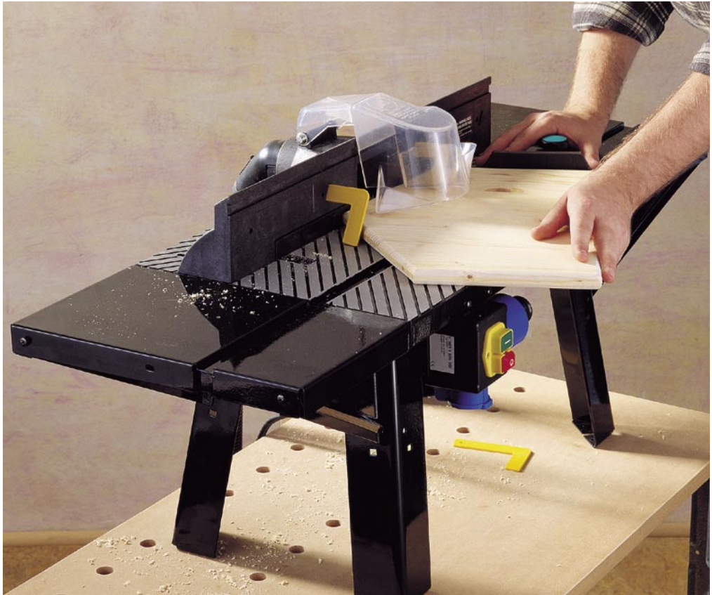
La défonceuse est transformable en toupie grâce à une table d'usinage.
