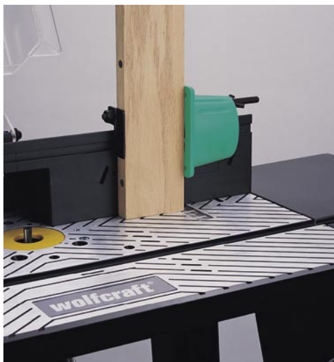
Certains modèles permettent d'usiner le bois debout.
