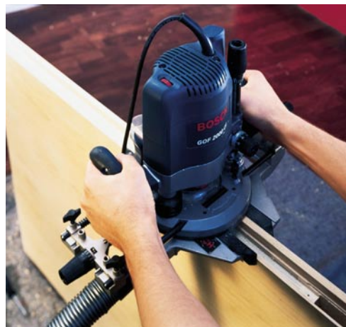
Le double guide parallèle permet le travail sur chant.
