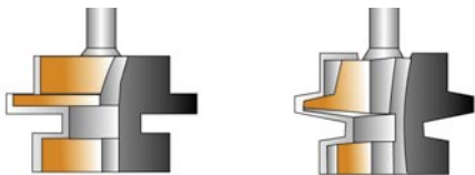
Fraise à bouveter (droite)
